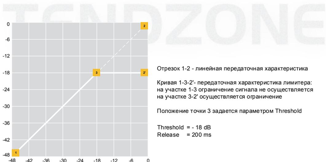
Рис. 25. Передаточная характеристика лимитера
